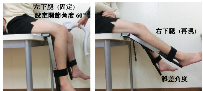
左下腿を椅子面から 設定関節角度(30°45°60°)に固定する 運動錯覚場合は左膝に振動刺激を与える
